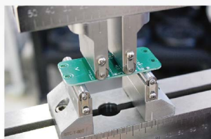
PCB 板弯曲疲劳测试
